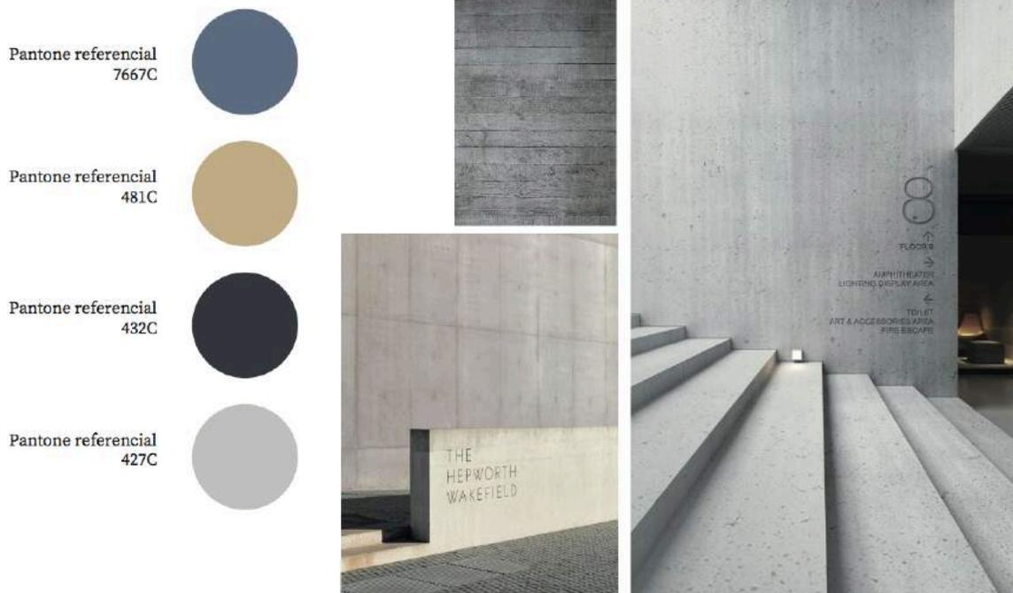
Se propone un sistema de orientación y direccionamiento con piezas monolíticas en materiales pétreos u hormigón, el que puede ser natural o bien pigmentado, con un acabado y sello de acrílico para su protección y mantención.
